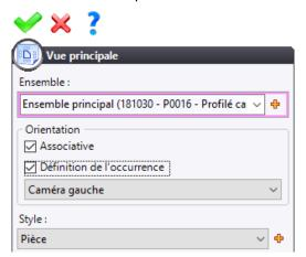
Queste opzioni consentono di mantenere questa fotocamera e l'orientamento da qualsiasi profilo dell'assieme. Questo sarà utile perché vogliamo mantenere la stessa disposizione della messa in tavola e poco importa la posizione del profilato nell'assemblaggio.
