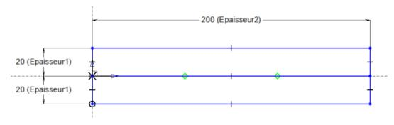
• Selezionare il comando **Modellazione > Forme locali > Estrusi.** Nel campo **Sezioni** selezionare un primo rettangolo dallo schizzo creato in precedenza. Nel campo **Limite** assegnare *Lunghezza=400mm*.
