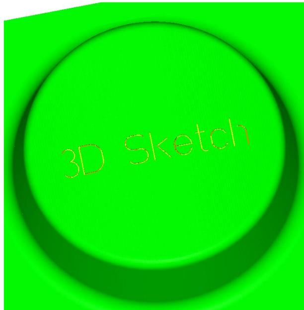
Useremo ancora una volta la contornatura 3D per eseguire un'operazione di fresatura sul profilo di una forma curva.
