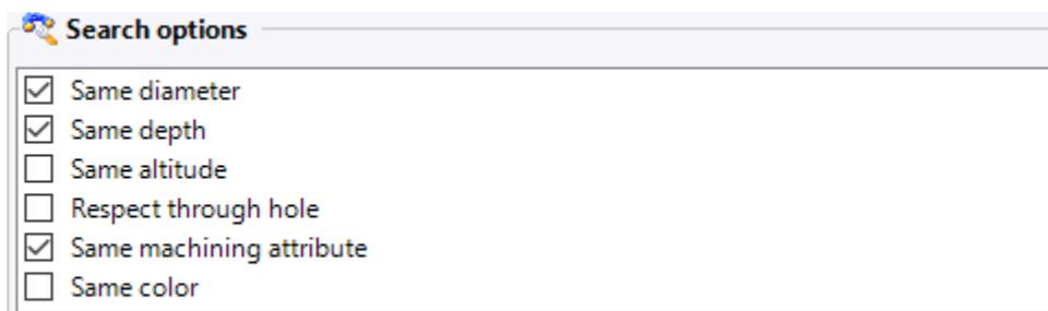
In questo caso, **TopSolid** cercherà cilindri con lo stesso diametro e profondità. Ciò contribuirà a risparmiare tempo ed evitare di dover selezionare ogni buca una alla volta.
